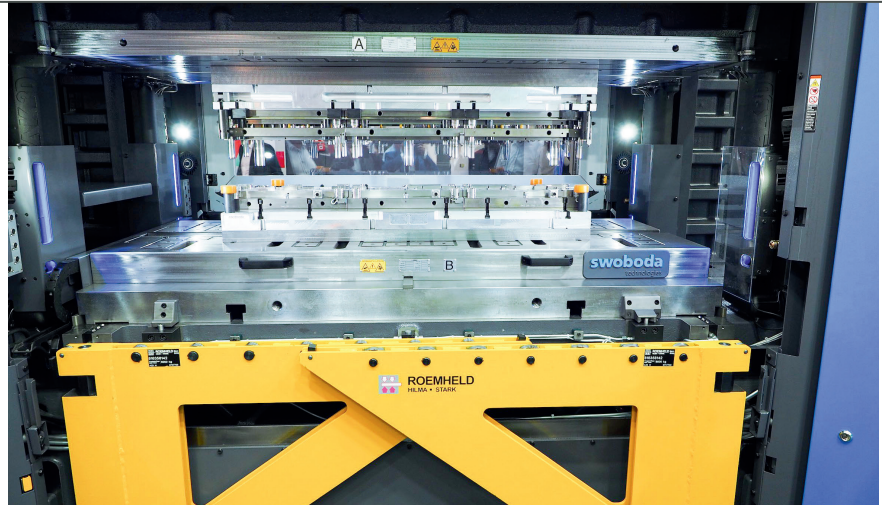
Gut gerüstet: Die schwenkbaren Tragkonsolen für die Presswerkzeuge sind an der Presse fest montiert © Roemheld
