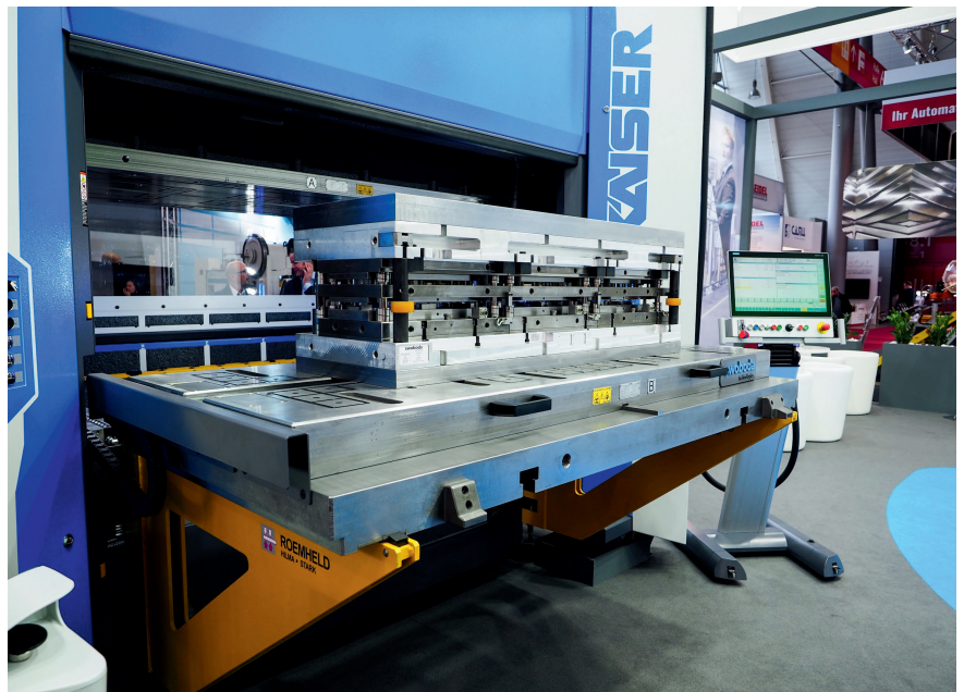
Für Kran und Gabelstapler zugänglich: Fahrtisch, Magnetspannplatte und Werkzeug lassen sich auf einer Tragkonsole aus der Presse ziehen. © Roemheld
